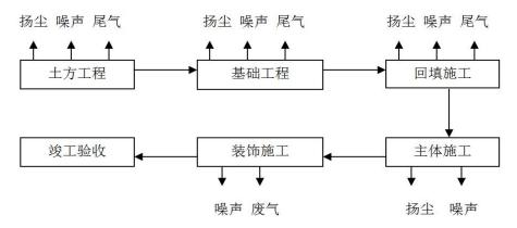
图 2.2-5 项目建设流程及污染物排放节点图
