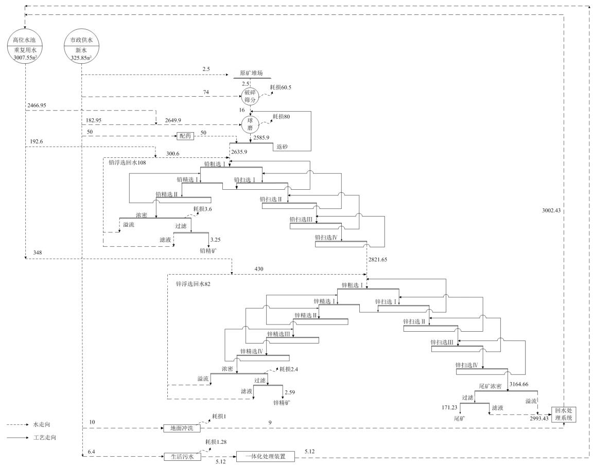
图 2.2-4 <u>全厂水平衡图(m³/d)</u>
