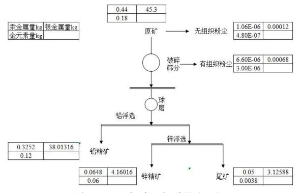
图 2.2-3 汞、金、银元素平衡图(kg/d)
