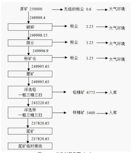
图 2.2-1 总物料平衡图 (t/a)
