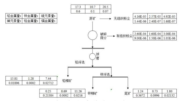
图 2.2-2 <u>铅、锌、硫、砷、铬、镉元素平衡图(t/d)</u>
